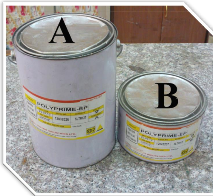
الشكل (1-3) راتنج الأيبوكسي مع المصلد نوع (Polyprime-EP) .
